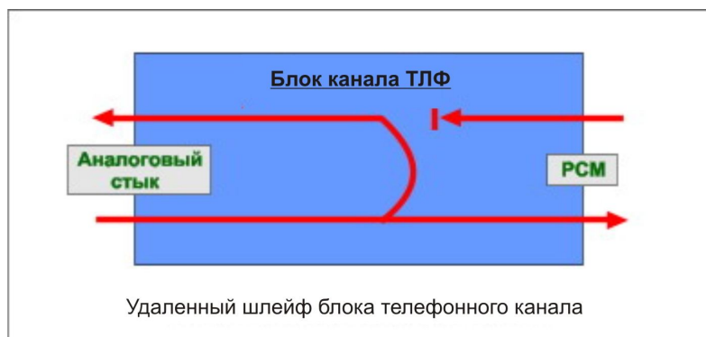
Рисунок 10 - Схема передачи сигнала при включенном удаленном шлейфе
