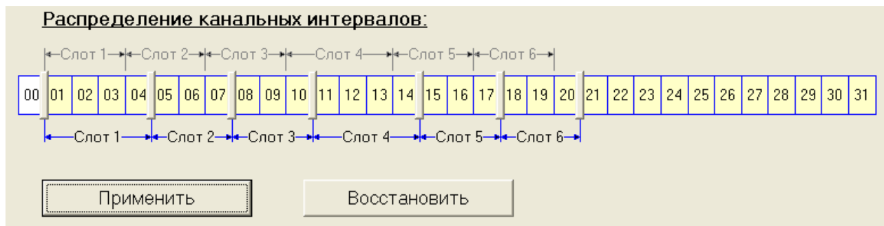
Рисунок 6 - Пример настройки количества КИ для карты, установленной в первый слот мультиплексора
