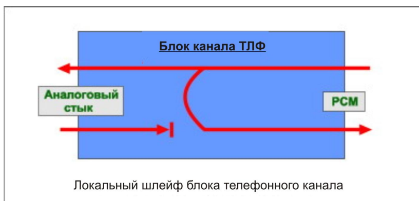
Рисунок 9 - Схема передачи сигнала при включенном локальном шлейфе
