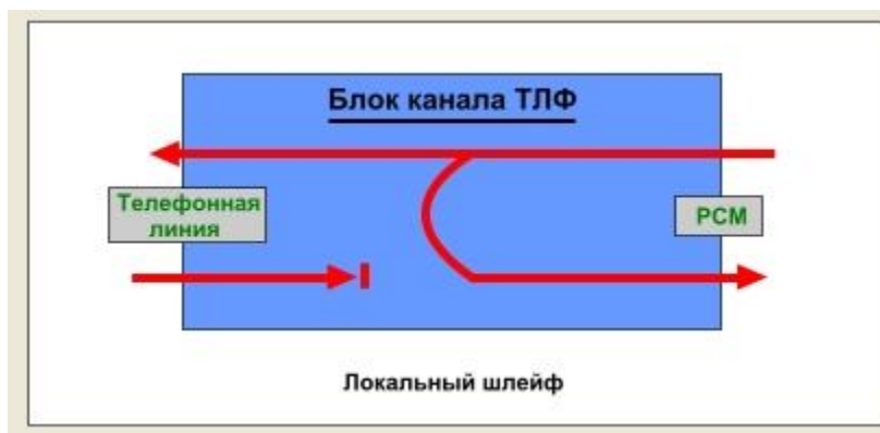
Рисунок 8 – Схема передачи сигнала при включенном локальном шлейфе
