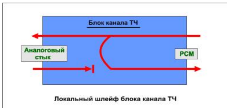
Рисунок 8 - Схема передачи сигнала при включенном локальном шлейфе
