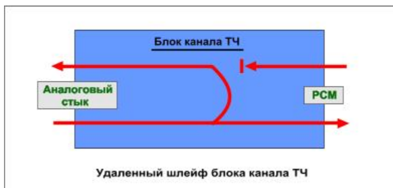
Рисунок 9 - Схема передачи сигнала при включенном удаленном шлейфе Примечание: возможно включение обоих типов шлейфов (см. Рисунок 10).
