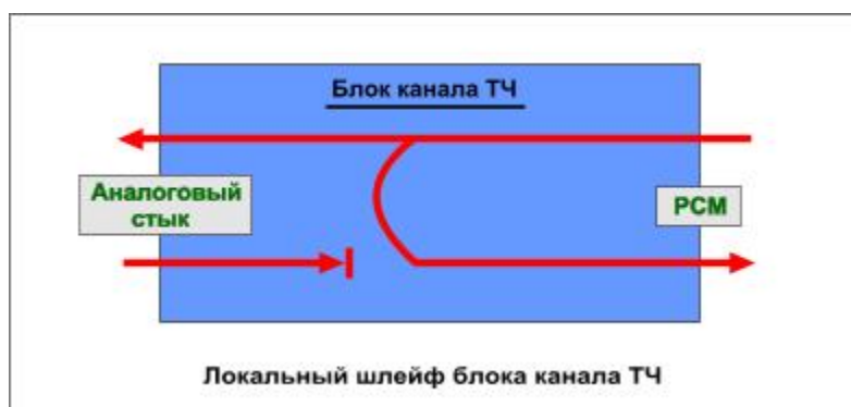
Рисунок 8 - Схема передачи сигнала при включенном локальном шлейфе
