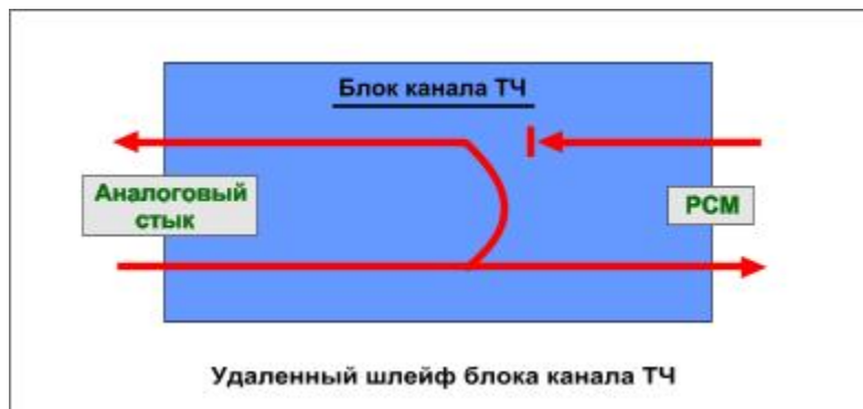
Рисунок 9 - Схема передачи сигнала при включенном удаленном шлейфе
