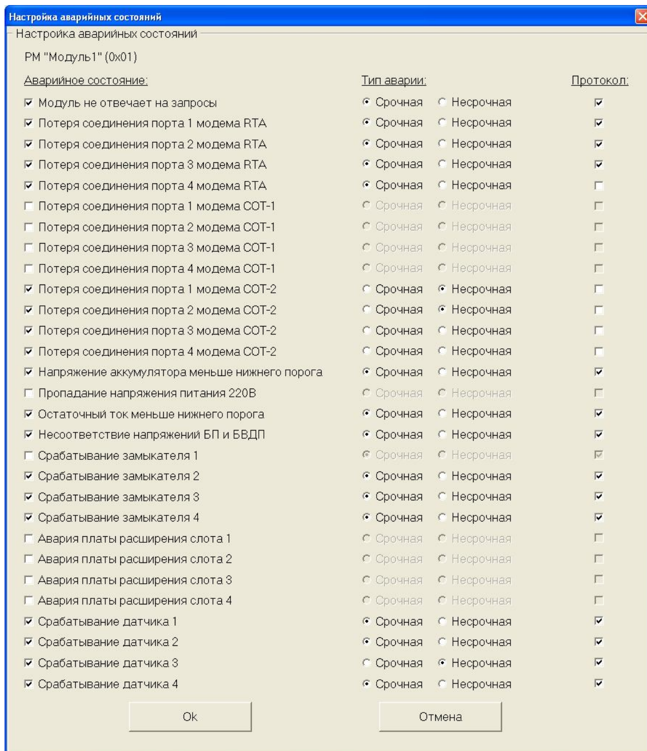
Рисунок 24 Настройка аварийных состояний (ПО “Поток-2”)
