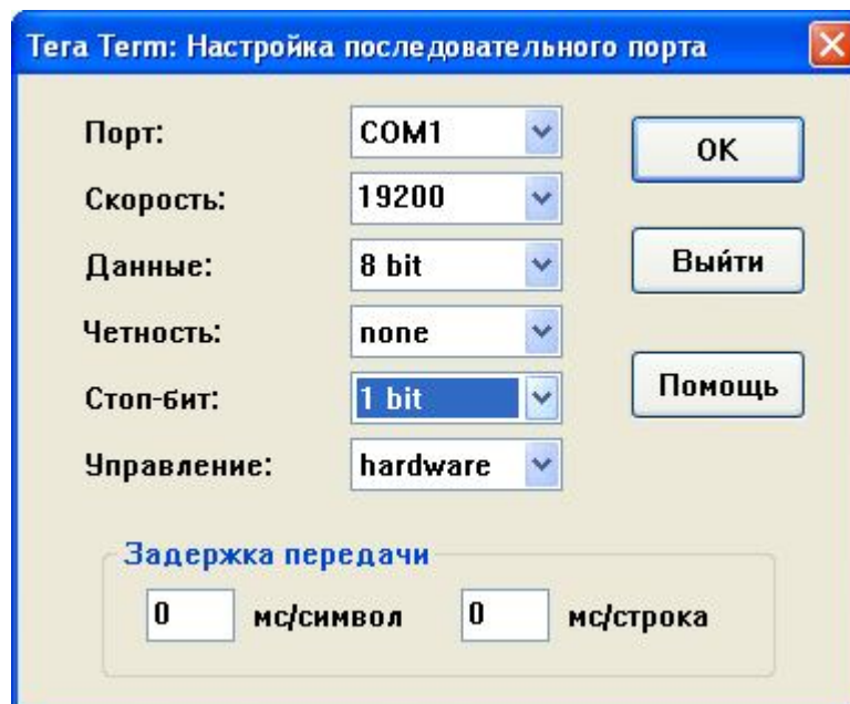
Рисунок Е.3 – Настройка COM порта для обновления ПО модема SHDSL-QS
